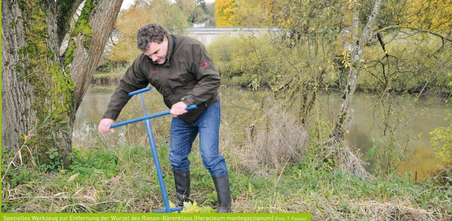
Spezielles Werkzeug zur Entfernung der Wurzel des Riesen-Bärenklaus ( Heracleum mantegazzianum ) (Foto: T. Paulus)
